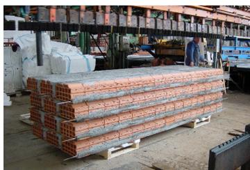
I vassoi traslano poi al limite della linea di produzione e passano nella zona di maturazione ad aria calda. Al termine del ciclo di maturazione, si procede allo sbanco dei pannelli con pinze elettromeccaniche ed alla creazione delle cataste.
