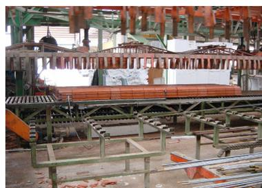
Nel frattempo, vengono preparate, su cavalletti esterni al carosello, le armature di progetto, che vengono poi posizionate nelle nervature da un sistema di pinze elettromeccaniche; la sporgenza delle barre viene controllata manualmente, in base alle disposizioni della distinta di produzione. La fase successiva consiste nel posizionamento manuale delle barre  $\phi 5$ , in acciaio nervato tipo FeB44K, nella scanalatura superiore dei laterizi.
