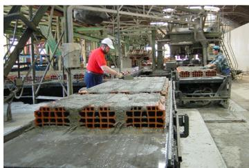
Si passa poi al getto del conglomerato con benna superiore fissa, con passaggio sotto il dispositivo di livellamento del conglomerato ed alla rifinitura manuale; il costipamento del calcestruzzo avviene tramite passaggio lungo una stazione vibrante. La fase successiva consiste nell'inserimento manuale dei ganci  $\phi 8$ , in acciaio liscio tipo FeB32k.
